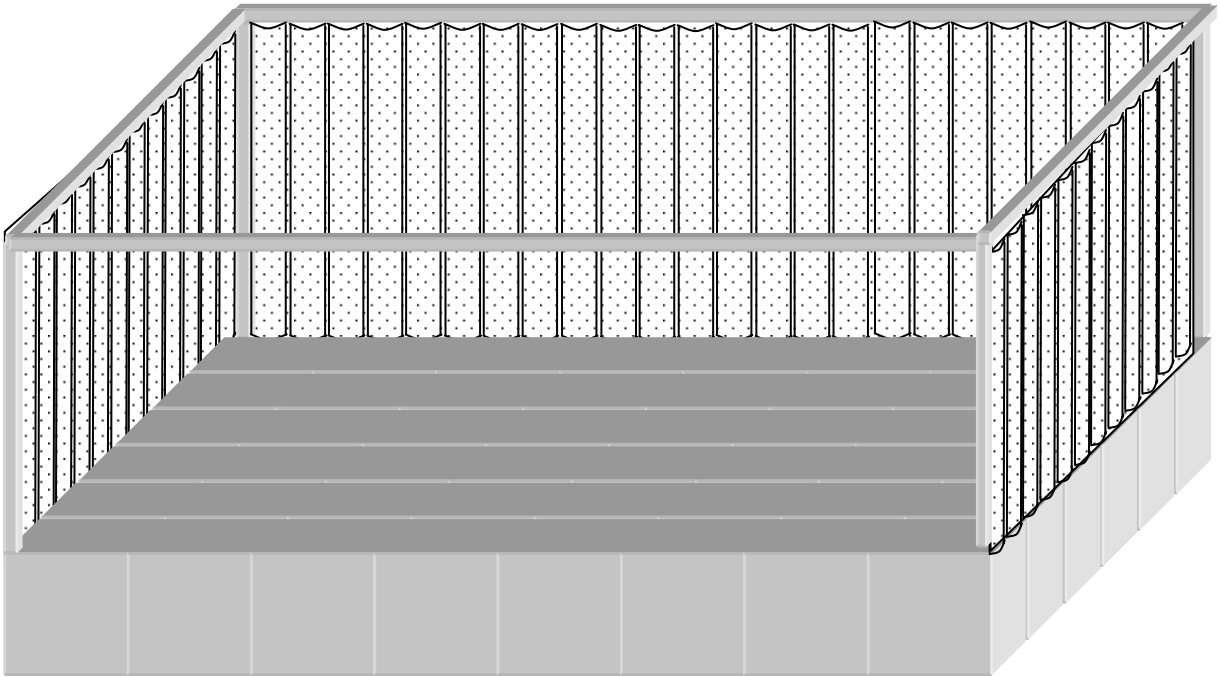
Caixa de Palco, Estrutura de Caibros e Cortinados
