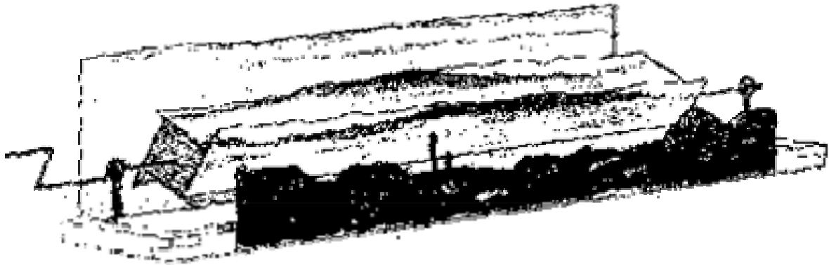
Máquina para produzir o efeito de ondas do mar. Aparatos semelhantes eram usados nos pavilhões de circo-teatro.
